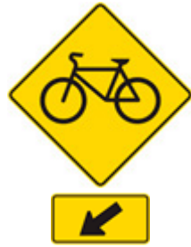
Figure 36 : Panneau de passage pour cyclistes
