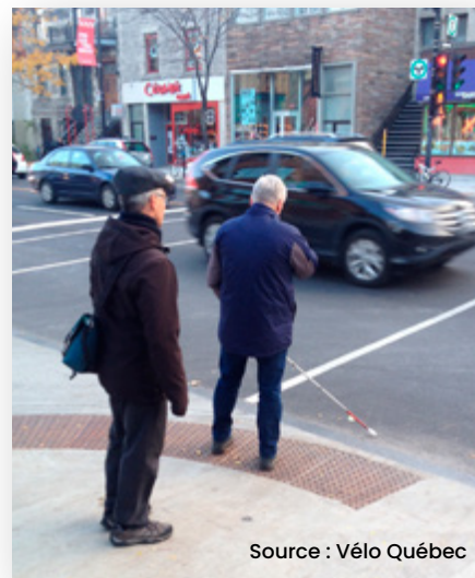
Figure 6 : Bande podotactile permettant de repérer le début et la fin du passage piéton
