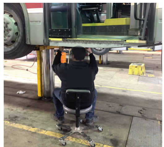
Le manque de hauteur sous le véhicule oblige les mécaniciens à travailler assis, une position non standard et non adaptée au travail.
