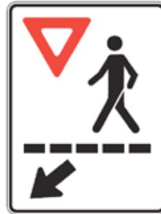
Passage pour piétons P-270-2
